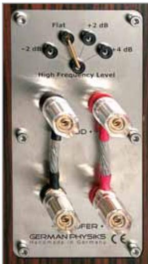
Morsetteria molto funzionale (accetta agevolmente banane e forcelle) e realizzata con notevole cura. Nella parte superiore vi è l'attenuatore delle frequenze più acute: grazie ad esso risulta possibile adattare al meglio l'emissione delle frequenze acute in relazione alle differenti situazioni ambientali.
