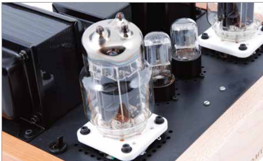
Particolare delle valvole tra cui spiccano le due 6C33C.
