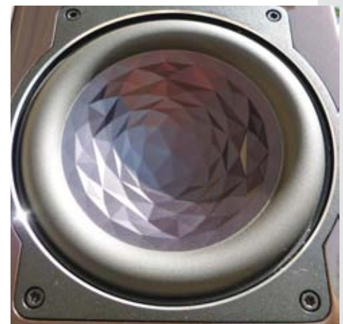
Il woofer da 15 cm ha la membrana irrigidita da originali nervature sfaccettate.
