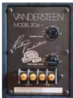
La morsettiere posteriore con i controlli della risposta in frequenza.
